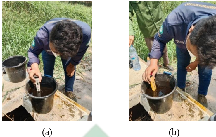
Gambar 5.1 Pengukuran Parameter secara Insitu pada Inlet IPAL TPA Ngipik: (a) Pengukuran Suhu; (b) Pengukuran pH
