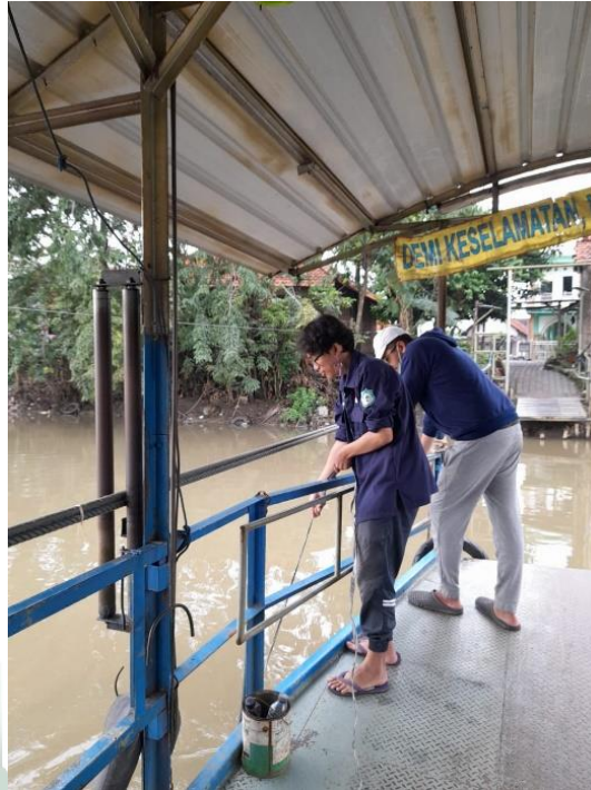
Gambar 4.4 Mengukur kedalaman sungai
