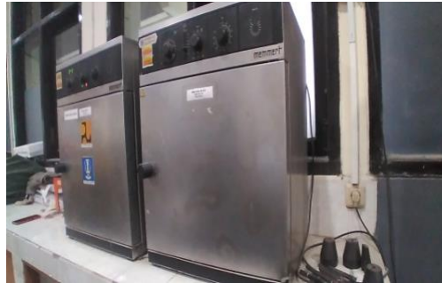
Gambar 4.5 Pengovenan Benda Uji
