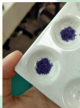
Gambar 4. 11 Hasil Uji Kitosan Dengan Ninhidrin
