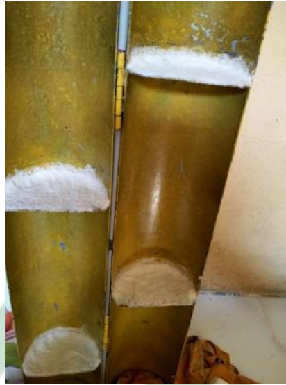
Gambar 4. 14 Kitosan Yang Ditempelkan Ke Dalam Plat Alat Bantu Uji
