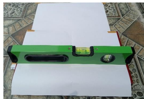
Gambar 4.6 Cek Kedataran Bidang Datar dengan Waterpass
