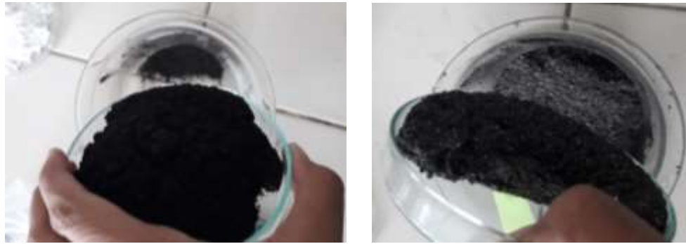
Gambar 4. 6 Pencampuran Arang Sampah Organik Dan Sabut Kelapa
