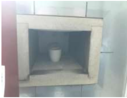
Gambar 4. 3 Karbonisasi Menggunakan Furnace
