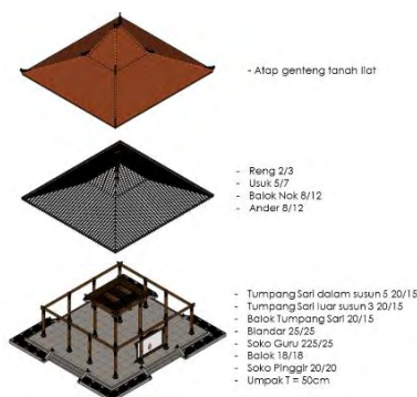
Gambar 4. 14. Detail Kontruksi Joglo (Sumber: Dok. Pribadi, 2022)
